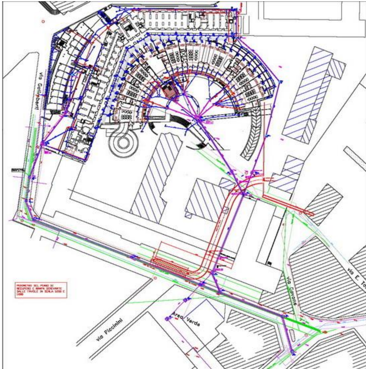
Progetto rete di fognatura del Tribunale di Asti, 2001.
